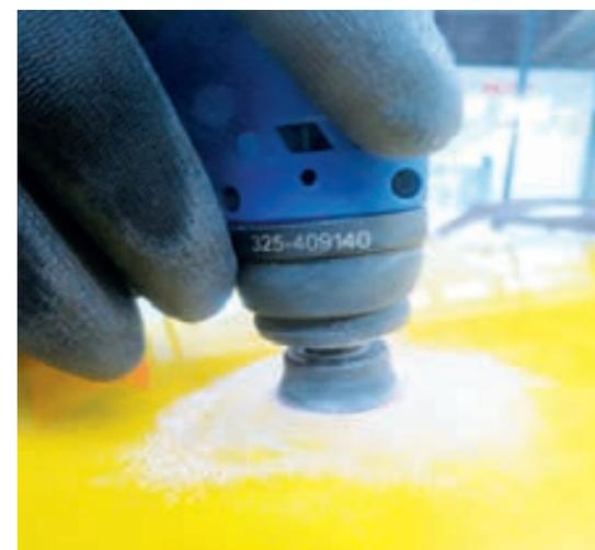
servan mínimas deformaciones en el relieve superficial de la zona donde se ha trabajado que afectan a la capa de barniz. Éstas se pueden eliminar con lijado fino (1500) o muy fino (P2000), seguido de un pulido a máquina y el posterior abrillantado.
