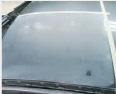
A continuación, se evalúa la necesidad de intervención. En zonas concretas, se necesita lijar más a fondo y aplicar masilla de relleno e, incluso, reenmasillar. En algunos daños se observa que la chapa se ha estirado y, al no estar recogida, puede acarrear problemas en el relieve de la pieza. En otros de los daños se ha observado que el relieve de la reparación está más alto (cresta) que el resto de la pieza, lo que indica que la reparación de carrocería no está terminada.
