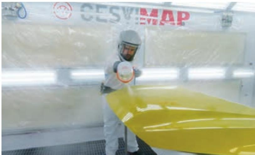
En los daños grandes levantados para pintar, el varillero no termina perfectamente el desabollado; esto se puede observar mateando la superficie con P500.
